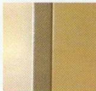
Hasil uji bakar brankast dengan temperatur \pm 1000^{\circ}\text{C} selama 1 jam
